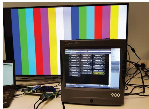
图 3. 英特尔的 HDMI 2.1 IP 通过 QD980 协议测试仪 8K 数据速率测试
