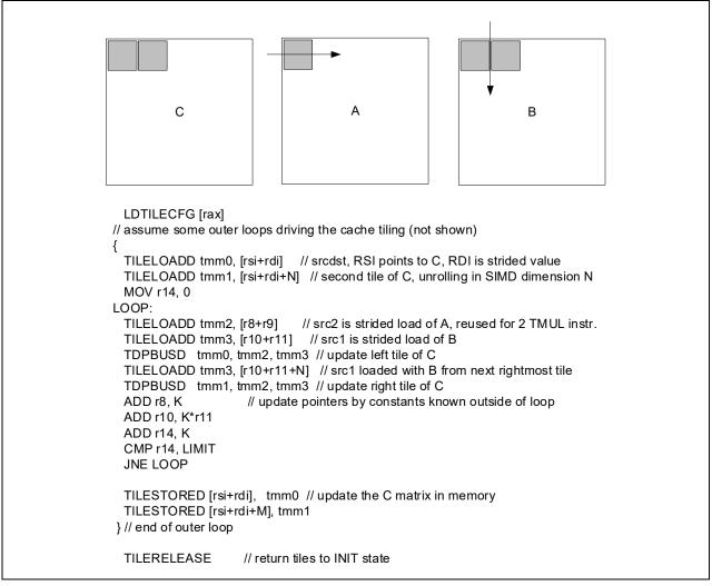
Figure 3-3. Matrix Multiply C+= A\*B
