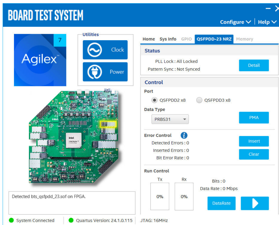
Figure 12. The QSFPDD-23 NRZ Tab
