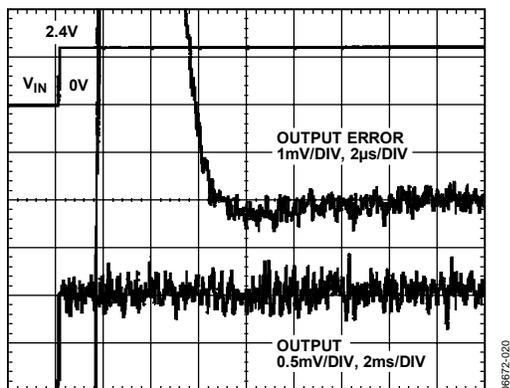
Figure 20. Turn-On Settling
